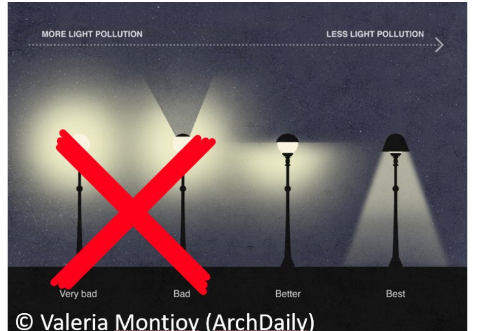
BREAM C kieltää käyttämästä valaisimia joista tulee valoa horisontaalitasoa yläpuolelle.
